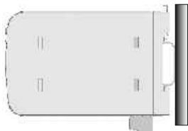
Rys. 3 Montaż na szynie TS-35 (DIN)
